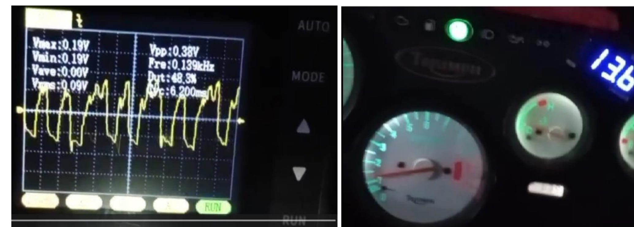
Figura 4: tensão elétrica medida na bateria em marcha lenta: A esquerda no osciloscópio Oscilação (RMS) de 0,09VCA; A direita no painel: 13,6 VCC
