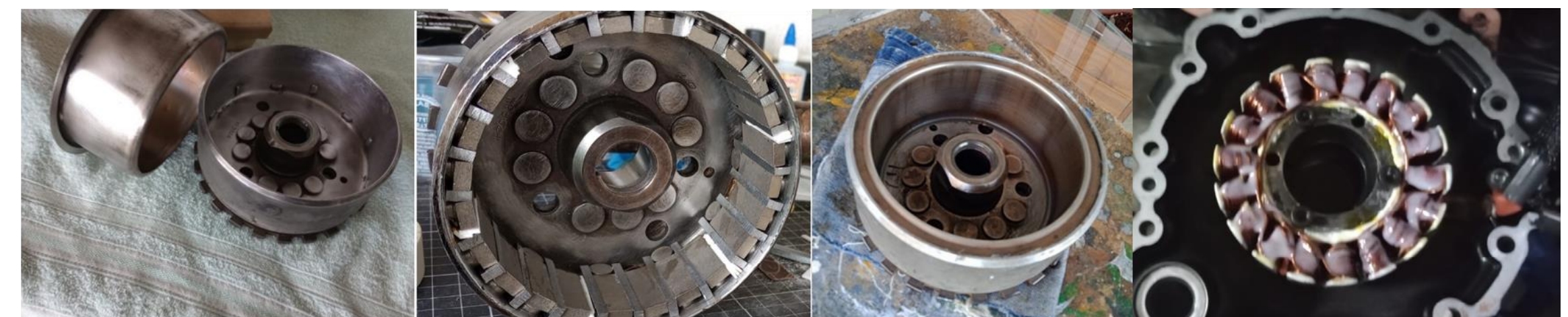
Figura 2: Volante de 24 polos magnéticos de Samário Cobalto e o Estator
