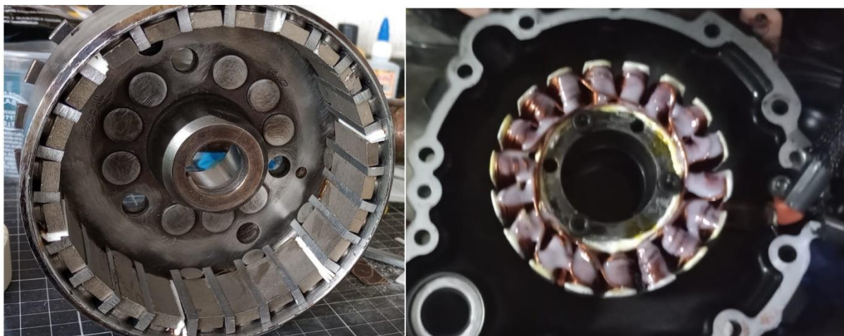
Figura 3: magneto com ímãs de samário cobalto com 24 polos e o estator trifásico construídos.
