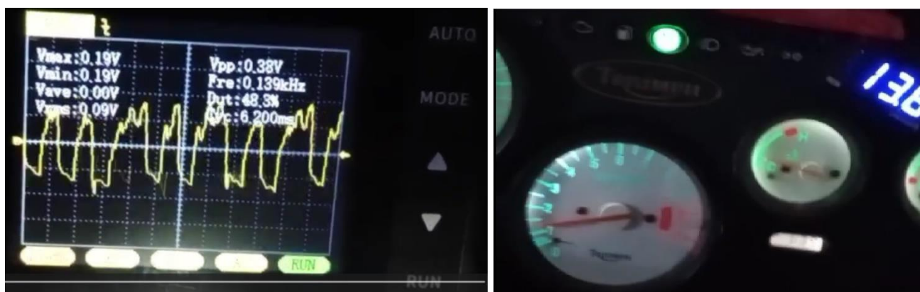
Figura 5: Tensão elétrica medida na bateria em marcha lenta: A esquerda no osciloscópio. A direita no painel
