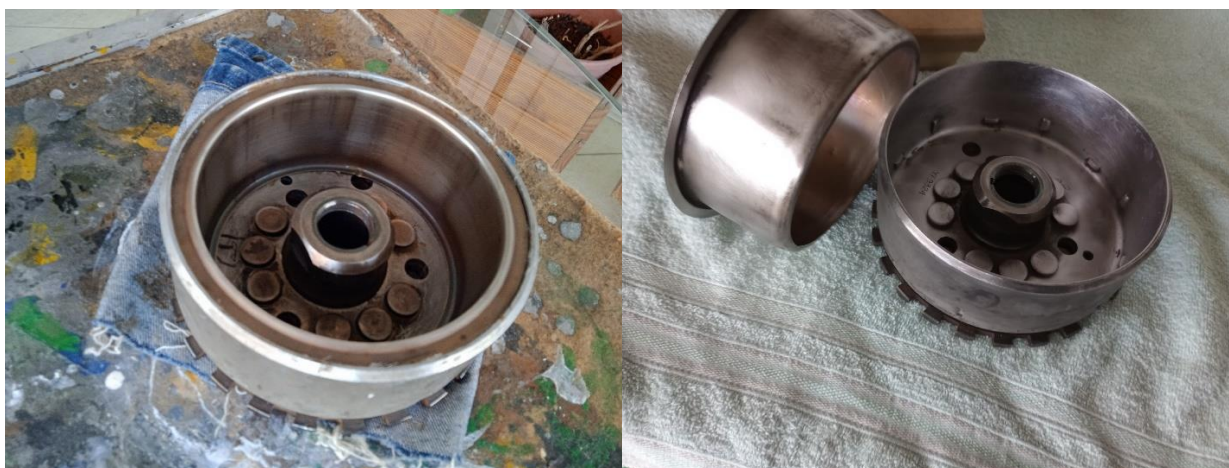
Figura 1: volante magnético original da Motocicleta Triumph Tiger 955i ano/modelo 2004
