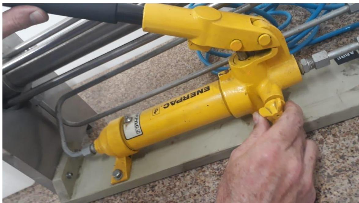
Através dos parafusos e porcas, é ajustado o comprimento da Trava Mecânica de modo a manter a pressão estabelecida pela prensa hidráulica. Com esta Trava, evita-se o vazamento excessivo de fluido no Filtro Prensa.
