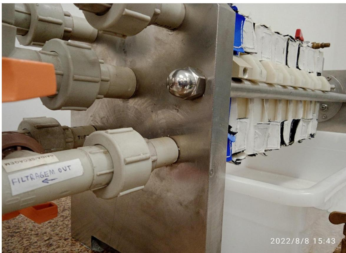
O Protótipo de Trava Mecânica foi construído utilizando um eixo tubular de origem automotiva e que havia sido descartado. Ele foi cisalhado ao meio, dividindo-o em duas partes iguais. Dois parafusos de diâmetro 10mm com porcas e arruelas lisas mantém a pressão nos filtros.
