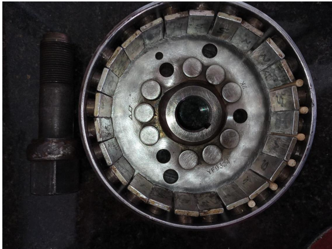
A tensão elétrica gerada em marcha lenta pelos imãs de terra rara foi de 23 volt, acima do valor mínimo padrão. A 5000 rpm, a tensão elétrica gerada ultrapassa os 80 volt
