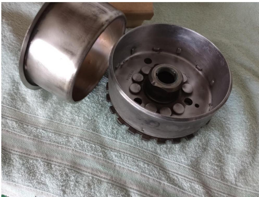
A primeira tentativa foi a fabricação de novos imãs de ferrite, como o original, mas devido ao processo quase que artesanal de fabricação, ficaram aquém do desejado. A tensão elétrica gerada por eles foi de apenas 15 volt, abaixo do valor mínimo recomendado de 20 volt, em marcha lenta. A 5000 rpm deveria ser de 70 volt, mas não chegou a 60 volt.
