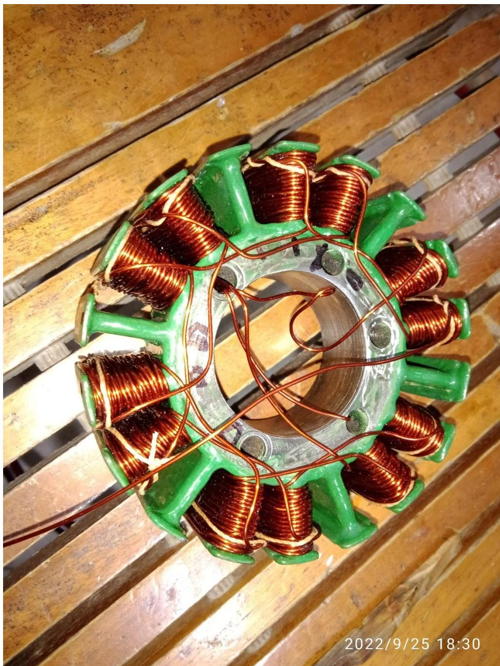
A solução foi a substituição do material e da forma de fazer o isolamento do núcleo do estator.
