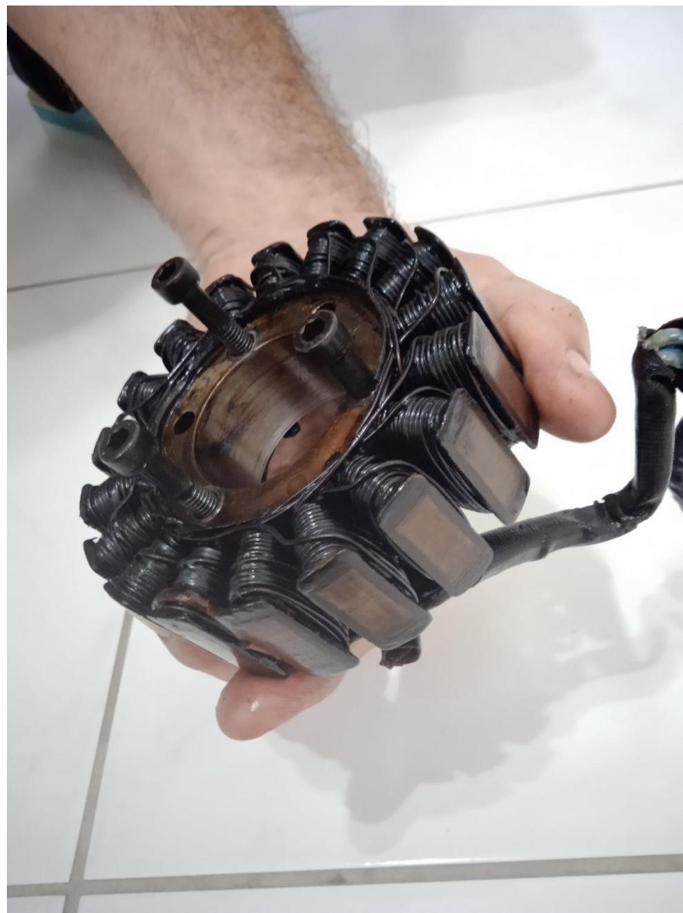
A primeira tentativa de utilização de resina epóxi feita de modo artesanal resultou numa camada muito espessa e irregular de resina. Com isto somente foi possível rebobinar o estator com 28 espiras cada bobina. Resultado: o estator não conseguiu gerar a energia necessária para a motocicleta.
