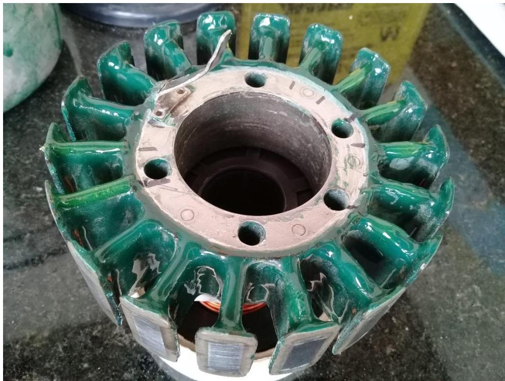
Na segunda tentativa a camada de resina foi feita o mais fina possível, pequenas imperfeições no isolamento foram corrigidas durante um mês. Desta vez o estator comportou 42 espiras do fio de cobre esmaltado 19AWG. Mas quando o estator foi montado na motocicleta, devido à alta temperatura do motor, o isolamento foi rompido fazendo com que o estator entrasse em curto-circuito, deixando de gerar energia elétrica.
